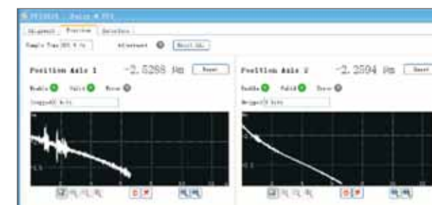
激光干涉仪实时测量纳米位移台水平和垂直方向位移的结果
