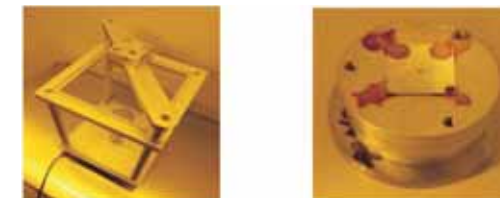
a.自行设计的OSA离线对准装置 b. 加装OSA后的掩模光栅
