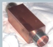
Undulator前端区光子吸收器
