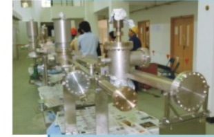
不锈钢真空室
