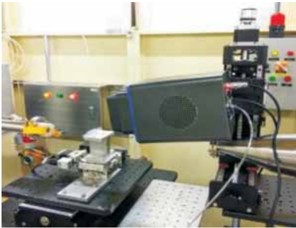
利用Pilatus 200k进行SAXS/WAXS联用的现场安装图示
