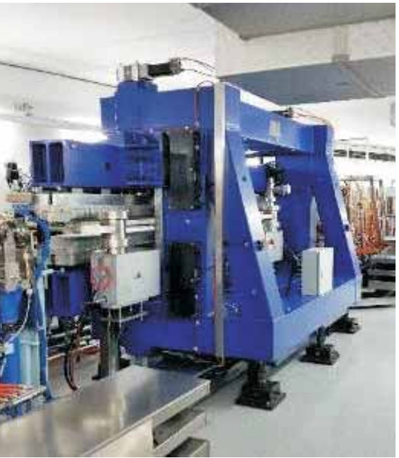
安装在上海光源储存环上的A-K波荡器
