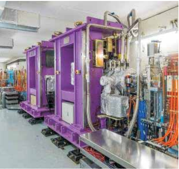
安装于隧道中的CPMU（右为CPMU，左为17U常温真空内波荡器）
