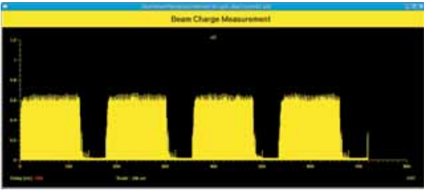
多脉冲注入时的储存环填充模式（均匀性~3%）
