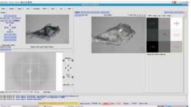
利用微细Raster 扫描来定位微细小晶体
