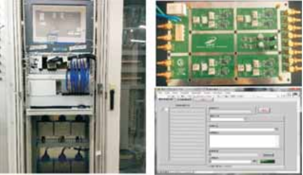
高频故障快联锁分析系统。左为机柜图片，右上为自制的IQ解调模块，右下为故障归档界面。
