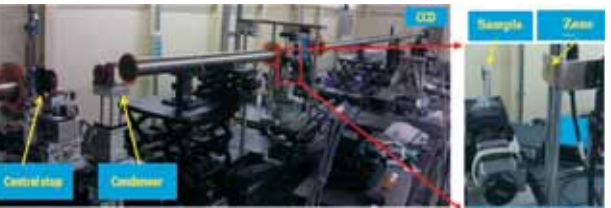
BL13W全场纳米成像实验装置布局
