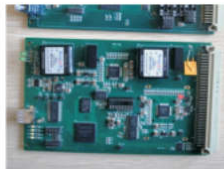
新版纯FPGA网络接口电源控制器
