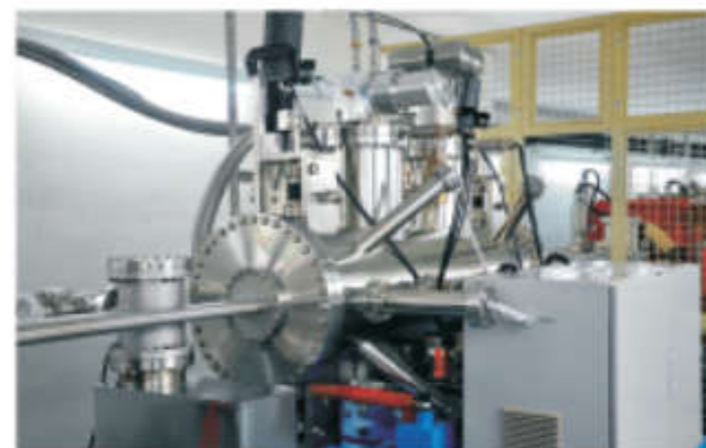
安装于储存环C04单元的超导波荡器热负载测试装置
