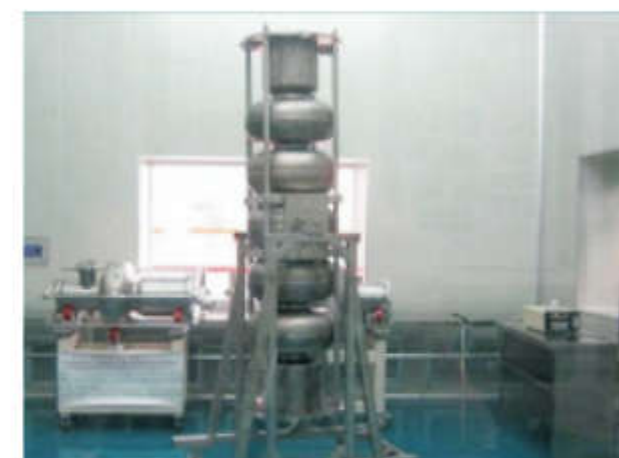
500MHz 5-cell超导腔体
