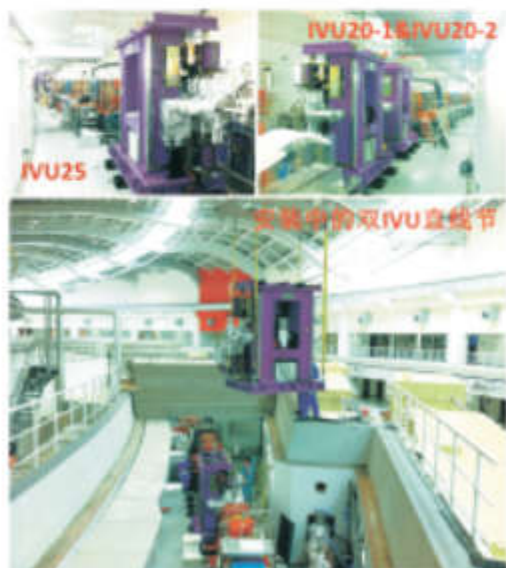
SSRF储存环新增三台真空内波荡器
