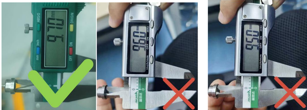
图 2. 市场上存在一些底座下部开口不符合标准规格的产品，购买时请注意辨别。
