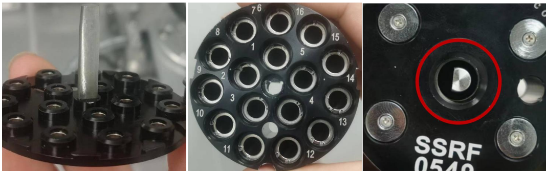
图 4. Puck 中间的定位杆和 16 个圆洞中的磁铁卡扣不可缺失。Puck 正上方螺孔（上图红圈所示）不同厂家生产标准不同，请自带对应上样工具。
