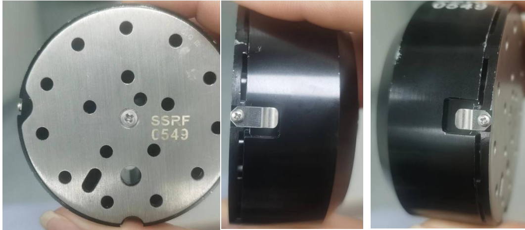
图 3. Puck 上有三颗螺丝，在使用过程中很容易松动，使用前务必拧紧。左右两个小卡扣不可缺失， 特别注意左右两个小卡扣应该是一长一短。
